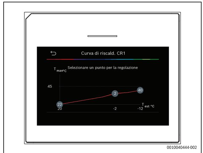
Fig. 1 Schermata iniziale per l'impostazione della curva termocaratteristica di riscaldamento per il tipo di regolazione in funzione della temperatura esterna con punto base (e punto di comfort)
