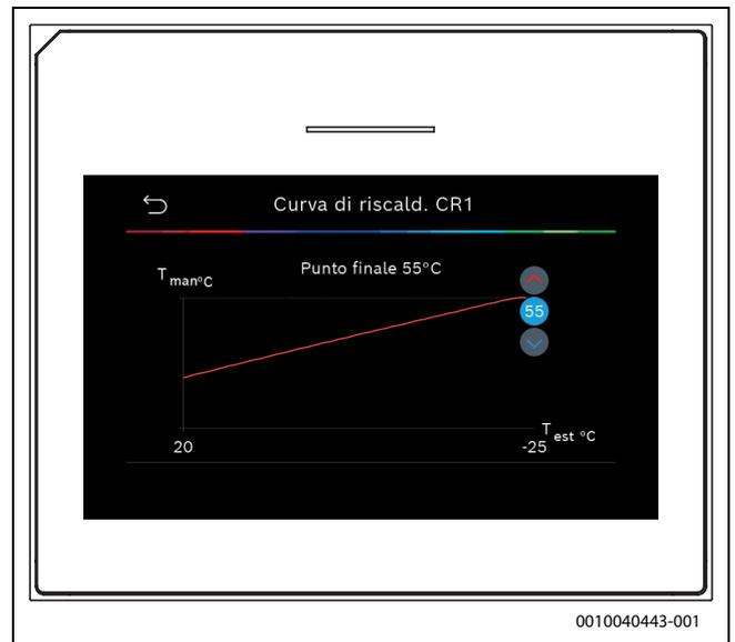
Fig. 2 Regolare il punto finale (solo se si è impostato il tipo di regolazione in funzione della temperatura esterna con punto base)
