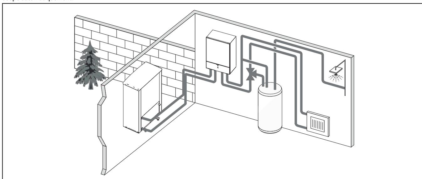
Fig. 3 Pompe à chaleur Compress 7000i AW, unité intérieure AWE avec chauffage d'appoint électrique et ballon d'eau chaude sanitaire externe
