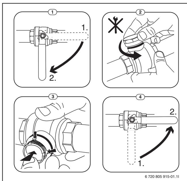
Fig. 8 Nettoyage du filtre
