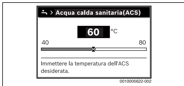
Fig. 11 Impostazione della temperatura dell'acqua calda sanitaria massima
